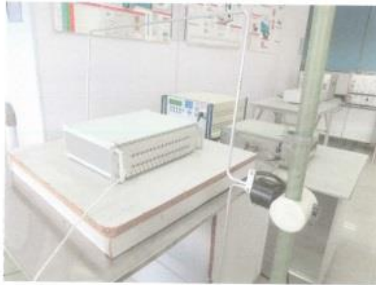
图 3 工频磁场抗扰度试验示意图
