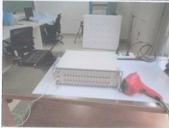
图 2 静电放电抗扰度试验示意图
