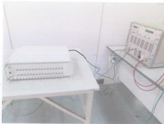
图 4 浪涌(冲击)抗扰度试验示意图
