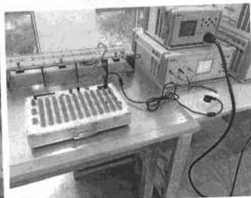
图 8 电快速瞬变脉冲群抗扰度试验
