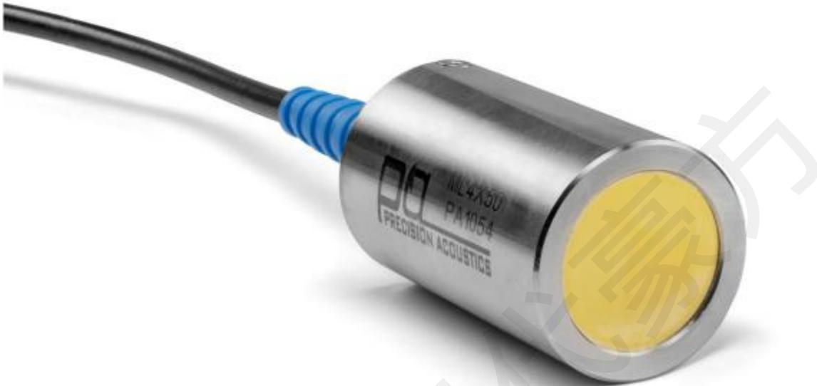
ML4X50是一款测量频率范围为100 kHz到1MHz的圆形平面活塞式浸没式水听器。该传感器由4层50微米厚的PVdF复合材料构成，提供平坦、宽带的灵敏度和显示出与圆形平面活塞理论模型极好相关性的直接性能图案。此水听器可以与我们的水听器增益放大器（订单代码HA1）配合使用。
